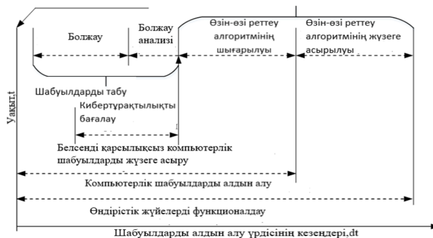
Сурет 5 – Компьютерлік шабуылдардың алдын алу үрдісінің барлық кезеңдері арасындағы қатынасты көрсететін уақыт диаграммасы
