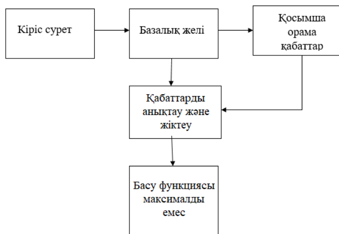
1-сурет. SSD моделінің жалпыланған архитектурасы
